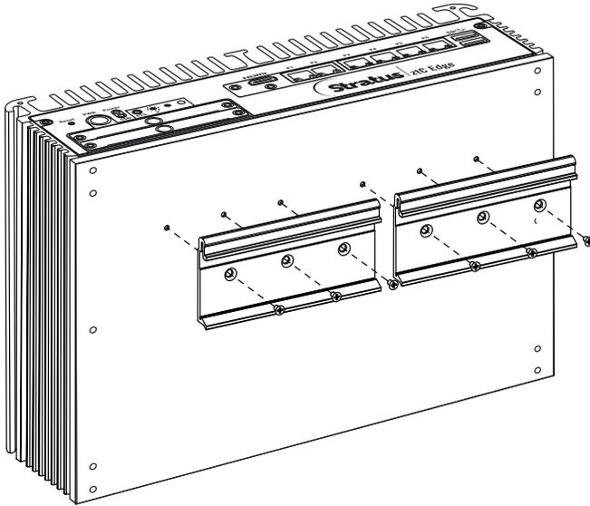
Um das Wandmontage-Set anzubringen, entfernen Sie die sechs M3-Flachkopfschrauben (12 mm) auf der Unterseite des Knotens (drei Schrauben auf jeder Seite). Verwenden Sie diese sechs Schrauben, um das Wandmontage-Set anzubringen.
