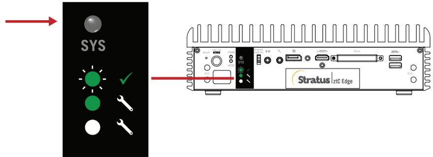
**2** Ist der fehlerhafte Knoten noch eingeschaltet, zTC-Konsole öffnen, um Probleme zu beheben, die das Herunterfahren verhindern. Zum Beispiel kann eine ausgefallene Netzwerkverbindung beim stabilen Knoten eine Abhängigkeit am fehlerhaften Knoten verursachen. Problem beheben und fehlerhaften Knoten herunterfahren.
