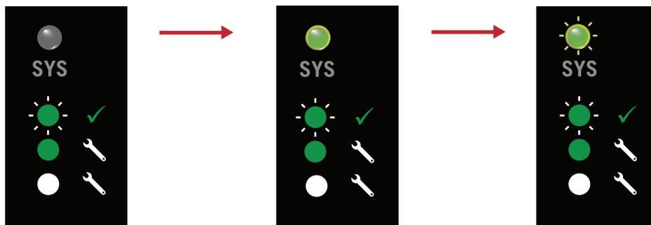
**6** Bei der ztC-Konsole anmelden, um die Systemintegrität zu überprüfen. Bei virtuellen Maschinen dauert die Synchronisierung u. U. Stunden. Danach sollte das Dashboard grüne Häkchen ohne Probleme anzeigen.
