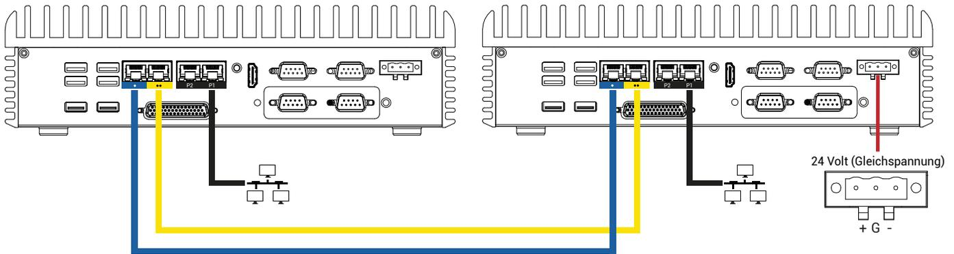
**5** Nach 20 Minuten wechselt die SYS-LED von aus zu durchgehend grün, um anzuzeigen, dass die Software auf dem Ersatzknoten startet. Nach weiteren 15 Minuten blinkt die SYS-LED, um anzuzeigen, dass das System in Ordnung ist.
