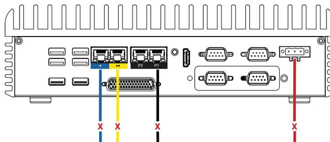
**4** Ersatzknoten in das System einfügen. Netzwerkkabel anschließen, dann Strom anschließen, um den Knoten automatisch einzuschalten. Der Knotenaustausch ist abgeschlossen. Das System beginnt ohne Benutzeraktion mit der Synchronisierung.
