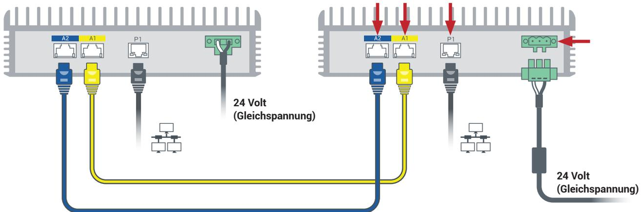
**4** Nach Anschluss des zweiten Knotens bis zu 20 Minuten warten, bis SYS-LED am zweiten Knoten blinkt und Schaltfläche **PM hinzufügen** auf der Seite **Physische Maschinen** verfügbar ist. Auf **PM hinzufügen** klicken. (Falls Schaltfläche inaktiv bleibt, überprüfen, ob die Lizenz aktualisiert wurde, die Verbindungen korrekt sind und der zweite Knoten eingeschaltet ist.)
