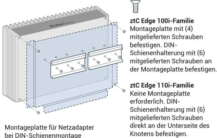
Montageplatte für Netzadapter bei DIN-Schienenmontage (Rückansicht)
