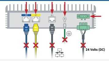
Adicione o nó substituto ao sistema. Reconecte os cabos de rede (e o cabo de aterramento de sinal, se houver) e, em seguida, o cabo de energia para ligar automaticamente o nó. A substituição do nó está concluída. O sistema começa a sincronização, sem precisar da interferência do usuário.
