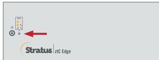
**2** 障害のあるノードの電源がオンになっている場合、ztC Edge コンソールを開いて、シャットダウンを妨げている問題を解決します。たとえば、正常なノード上でエラーとなったネットワーク接続が障害が発生したノードへの依存の原因である可能性があります。問題を解決して障害のあるノードをシャットダウンします。
